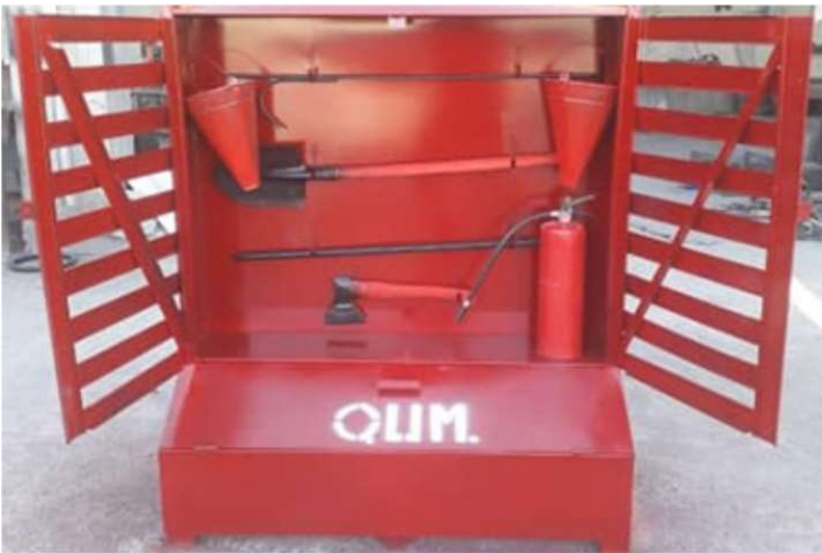
Уличный шкаф - Пожарный щит и ящик с песком - ПОСТ с баком под песок, комплектация - багор, лопата, топор, 2 ведра, лом. Ширина 1350/высота1400/глубина 470 мм
