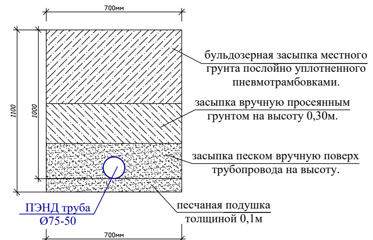
Разрез траншеи I-I
