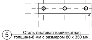
Узел "Г" Анкер пластина.
